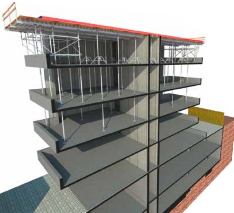
VIGA ALUMINIO PRIMARIA h=150
