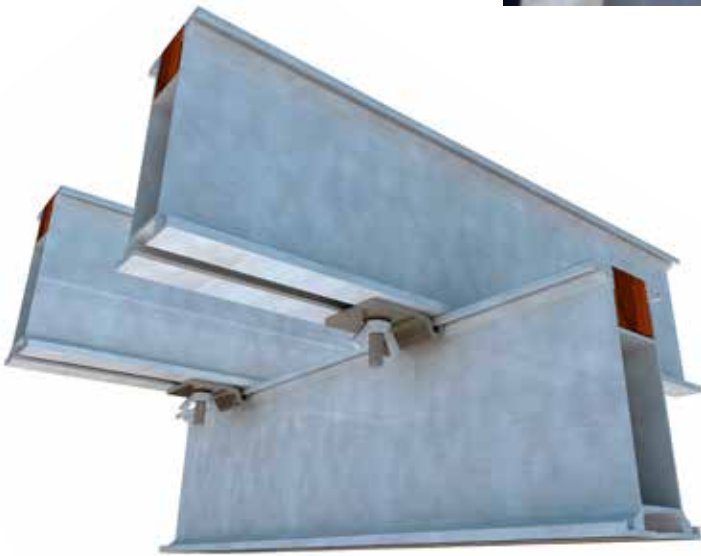
VIGA ALUMINIO PRIMARIA h=150
